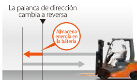
Regeneración por puesta en reversa
