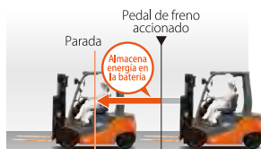
Regeneración por frenado
